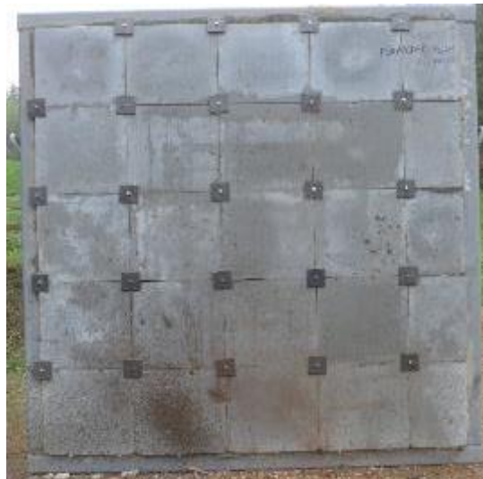
Po výbuchu nálože. Vzorek obkladu bez poškození, zeď i obklad zůstaly plně funkční.
