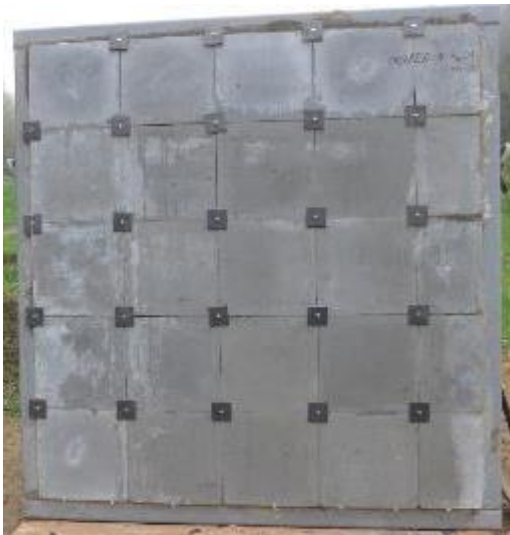
Obklad aplikovaný na porothermovou zeď před výbuchem nálože.
